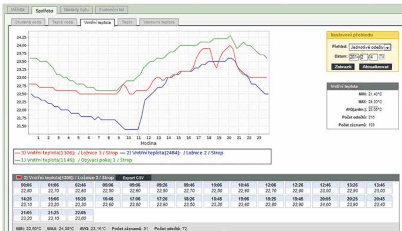
Snímek průběhu teplot bytu s online měřením
