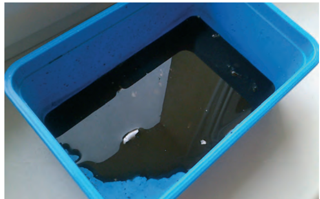
Kal odstraněný ze spodní části radiátoru
