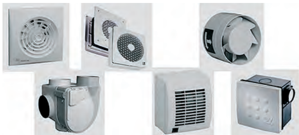
Decentrální odtahové větrání: ventilátory axiální pro větrání hygienických místností a malé výkony, radiální ventilátory pro delší potrubí a větší výkony, viditelné nástěnné a potrubní s vyústkou.
