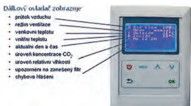
Dálková čidla ovládající talířové ventily a ventilátory a reagující na vlhkost či koncentraci CO 2 .
