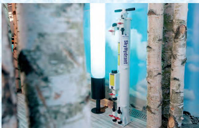
I přes malou velikost má zařízení ohromný výkon – bezmála 500 litrů za hodinu.
